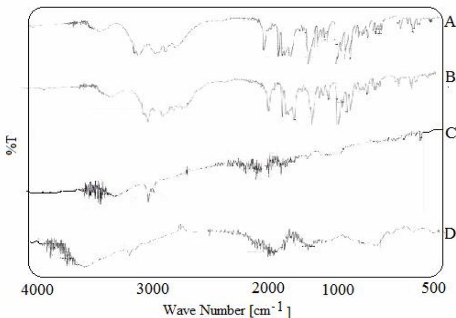
**Figure 1:** IR Spectrum of A) TMH B) TMH and polymer C) TMH microspheres D) Blank microspheres
